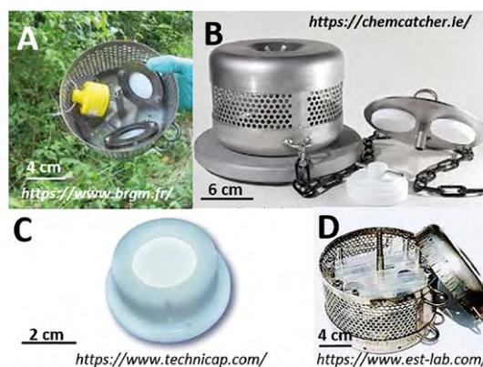
Exemple d'EIP de type A) POCIS, B) Chemcatcher®, C) DGT et D) SMPD avec leurs boîtiers et supports de fixation pour les ESU (voir tableau ci-dessous).
