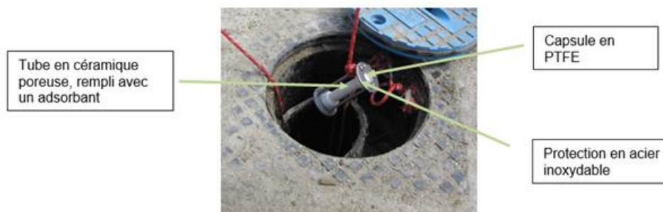
Figure 17 : Exemple d'échantillonneur passif intégratif de type dosimètre en céramique (Ineris-ADEME (2014))
