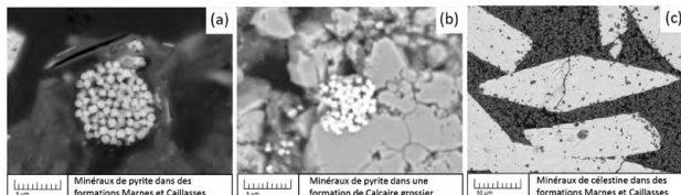
Image MEB. Les spectroscopies EDS associées révèlent que ces minéraux contiennent du molybdène.
