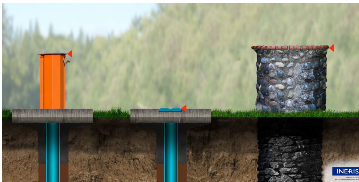
Figure 25 : Point de mesure de la piézométrie pour les différents ouvrages du réseau de surveillance (repère altimétrique, recommandé en m NGF en France métropolitaine)
