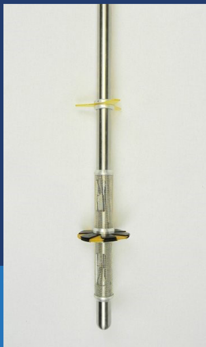
Figure 1 : Matériel nécessaire pour la mesure des flux verticaux naturels et des horizons productifs en pompage (sonde à gauche, treuil et centrale d'acquisition à droite)
