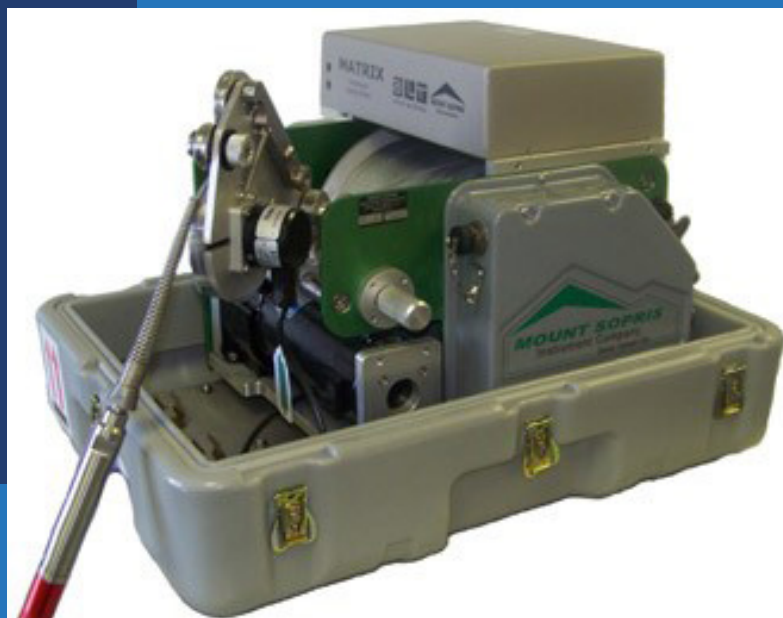
Figure 1 : Matériel nécessaire pour la mesure des flux verticaux naturels et des horizons productifs en pompage (sonde à gauche, treuil et centrale d'acquisition à droite)
