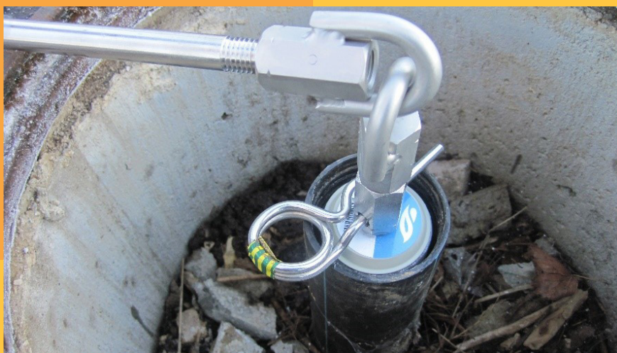
Figure 2 : Mise en place des échantillonneurs iFLUX
