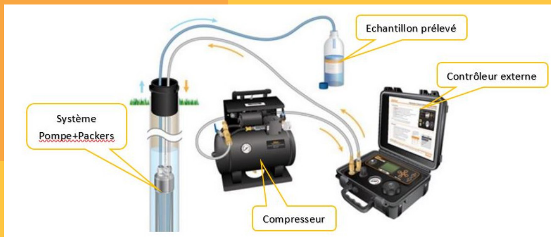
Figure 2 : Montage pour un prélèvement avec le préleveur bas débit entre obturateurs
