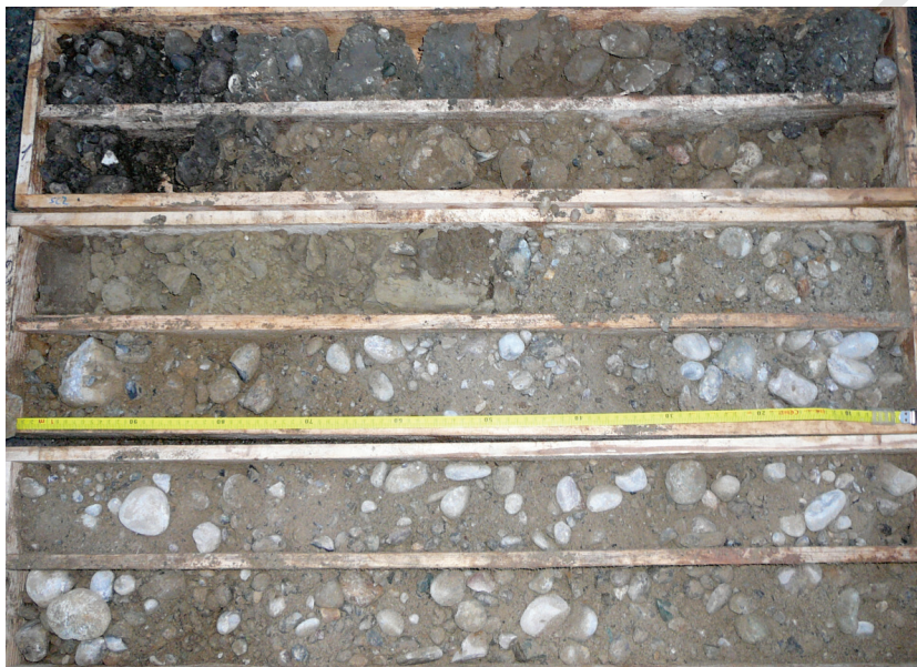
Figure 3 : Sondage carotté jusqu'à 6 m de profondeur (de haut en bas)
