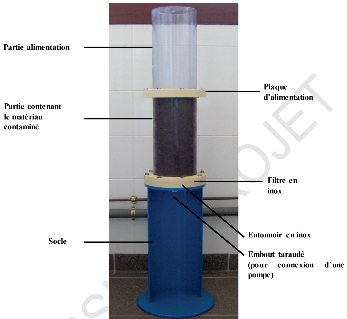
Figure 11 : Colonne utilisée pour les expériences de remontée de nappe et d'infiltration d'eau de pluie
