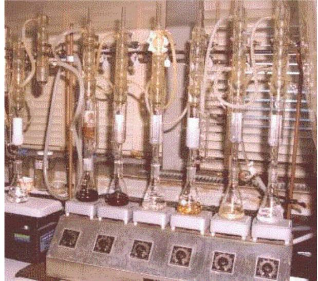
**Fig. 14 - Équipement d'extraction soxhlet.**
