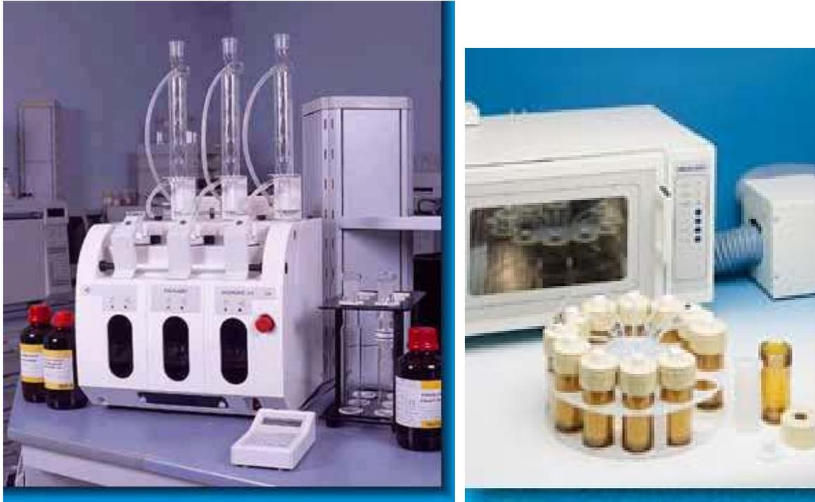
Fig. 17 - Extraction assistée par micro-ondes en systèmes ouvert et fermé.
