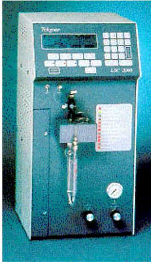
**Fig. 13 - Appareillage permettant l'introduction en chromatographie en phase gazeuse, des composés organiques volatils par la méthode de l'espace de tête dynamique.**
