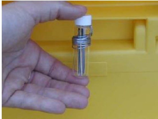
Vial contenant le préleveur passif, d'après Beacon Environmental Services, Inc,
