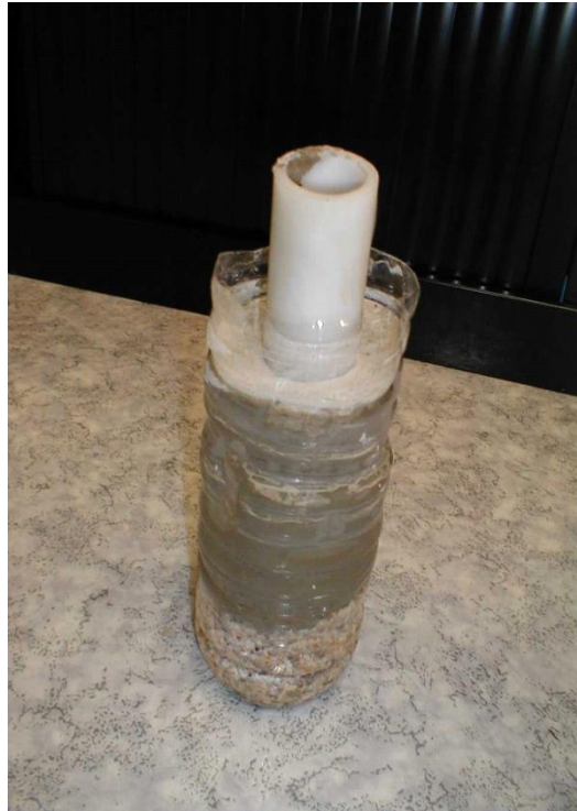
Figure 3 : Test en bouteille de l'efficacité d'un coulis bentonite-ciment (d'après Hazebrouck, 2008, document de formation)
