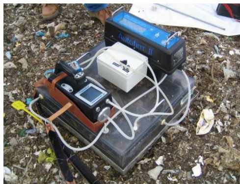
Figure 7 : Dispositif de chambre à recirculation en acquisition continue par FID (Telegan), PID et IR (Ecoprobe) pour le suivi en continu des émissions de COV, CH 4 , CO 2 et COVT
