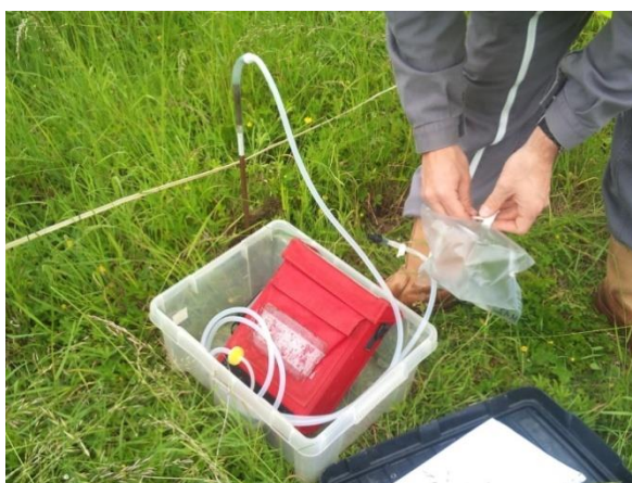
Figure 19 : Prélèvement et analyse de gaz du sol in situ par l'analyseur portable LFG20 et prélèvement de gaz en sac tedlar®
