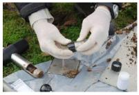
Tube de carottage acier Inox 200 ml rempli et bouché : Méthode peu connue des préleveurs en France alors qu'elle est couramment utilisée à l'étranger. Difficultés de rebouchage et de remplissage du tube.
