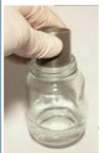
Carottage 20 ml sol - Flacons pré-remplis de méthanol : Méthode peu utilisée du fait d'un protocole contraignant sur le terrain et jugé parfois disproportionné par rapport à l'utilisation des résultats (selon les objectifs de l'étude).
